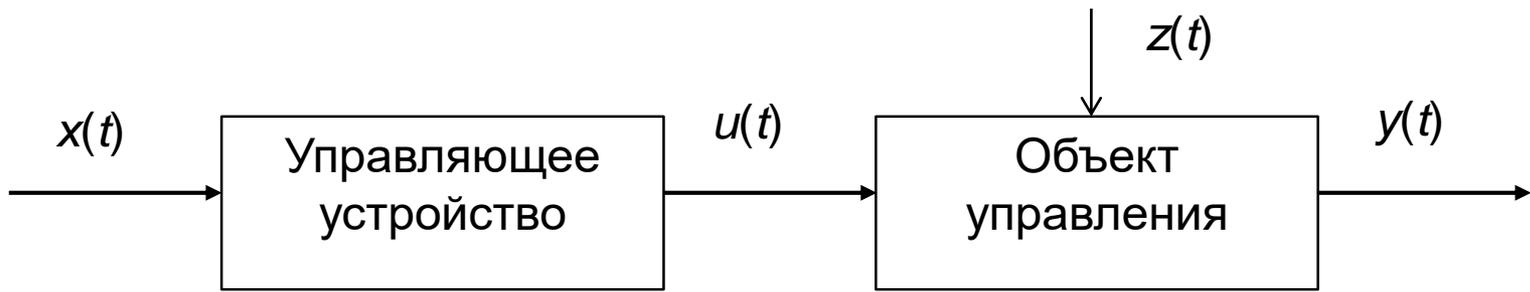
Рис. 3. Функциональная схема разомкнутой системы
