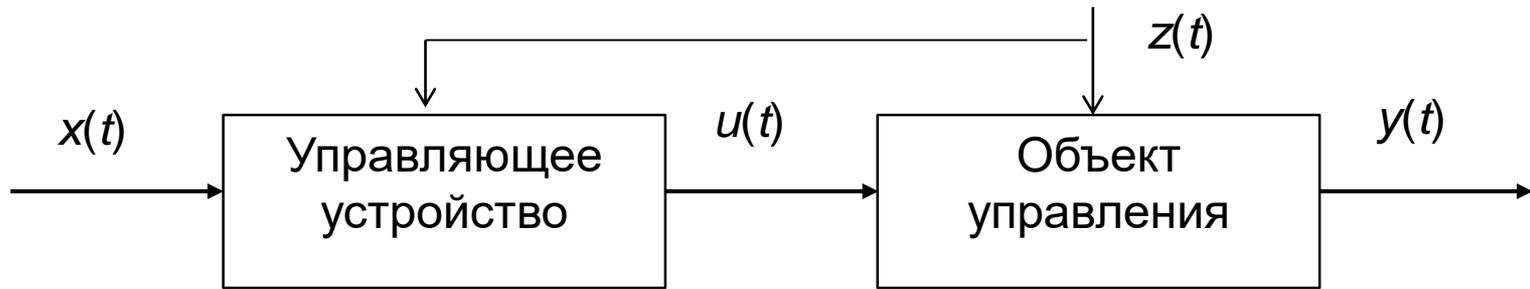
Рис. 4. Функциональная схема разомкнутой САУ с управлением по возмущению
