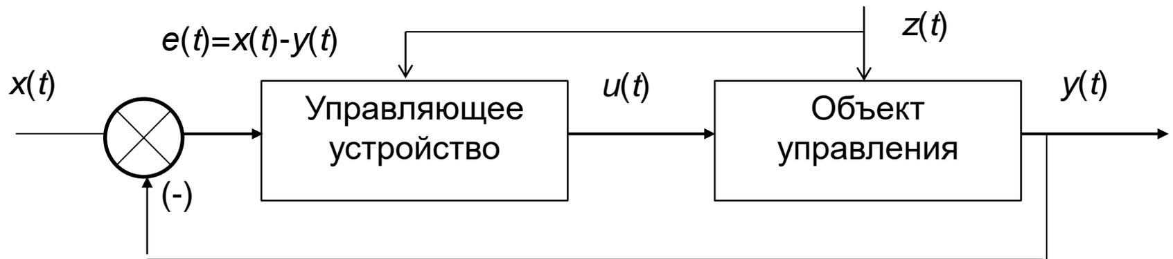
Рис. 6. Функциональная схема системы с комбинированным управлением по отклонению и по возмущению
