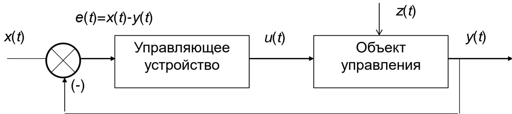
Рис.5. Функциональная схема замкнутой системы с управлением по отклонению
